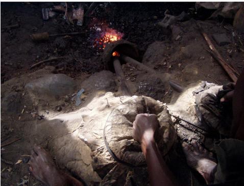
Ainsi l'air enfermé dans le bol est forcé et elle sort par un grand tuyau, qui se trouve dans la partie inférieure du bol. Le bout de ce grand tuyau se trouve justement dans la bouche du petit tuyau du foyer de la forge.
